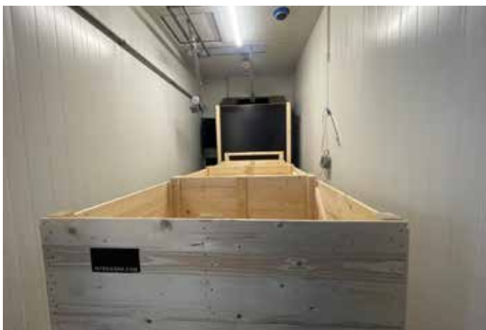
In den gasdichten Versuchsboxen können verschiedene Versuche mit Keimhemmungsmitteln durchgeführt werden.
