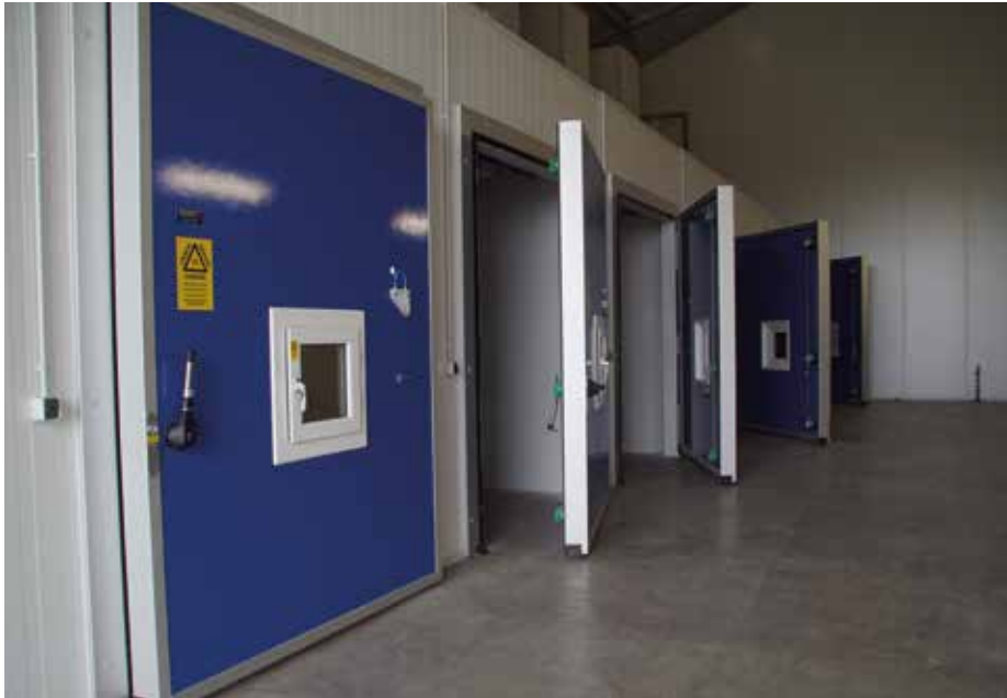
Die Versuchsstation bietet modernste technische Ausstattung zur Analyse und Steuerung von Lagerbedingungen – darunter sechs gasdichte Boxen mit automatisierter Regelung von Temperatur, Luftfeuchte, CO 2 -Gehalt und mehr.
